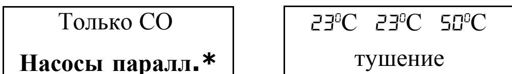
В этом режиме работа насосов начинается параллельно выше температуры включения насосов ( заводская установка на 35°C). Но эти температуры могут быть разными, в зависимости от их установки клиентом. Приводит это к неодновременному включению насосов, но, после превышения обоих этих порогов насосы будут работать вместе (параллельно). Насос CO (центрального отопления) работает все время, а насос ГХВ (горячей хозяйственной воды) выключается после достижения заданной на бойлере температуры.
