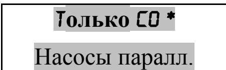
Выбирая этот опцион регулятор переходит в состояние отопления только дома. Насос CO начинает работать выше температуры включения насосов ( заводская установка на 35°C ), смотри п. II d . Ниже этой температуры (минус 3°C) насос перестает работать.
