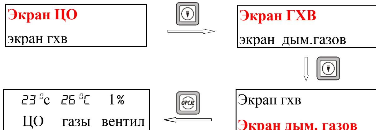
С левой стороны дисплея указана темпер. котла; по середине дисплея - температура выхода дымовых газов и справой стороны дисплея - мощность вентилятора. Чтобы вернуться в главное мени следует нажать клавиш .
